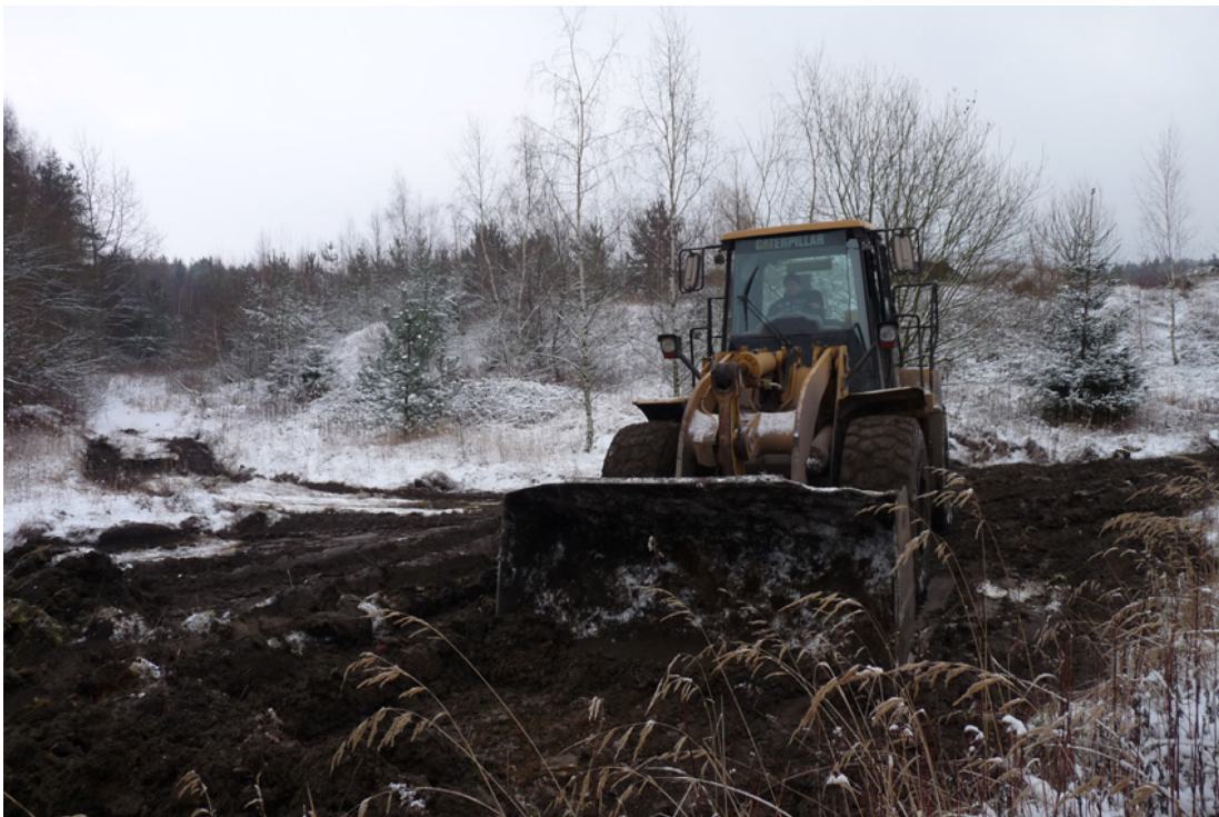
Abb. 3: Januar 2013: Einsatz eines 18,5 t Radladers zur Schaffung von Rohbodenflächen und Anlage von Kleinstgewässern. Foto: Mirjam Nadjafzadeh.
