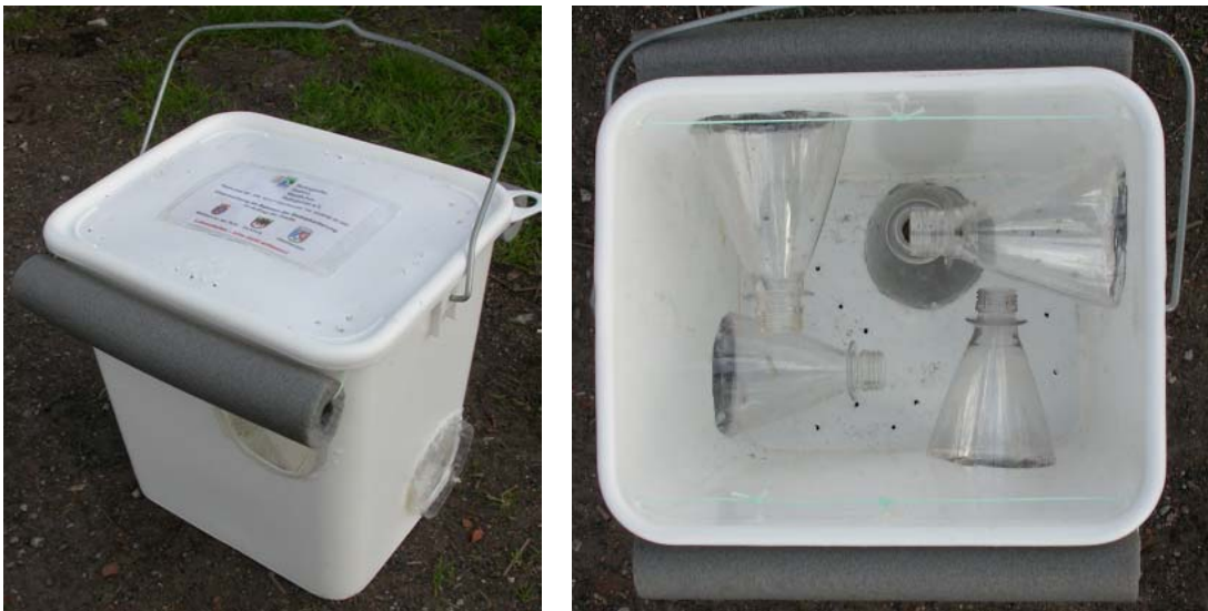
Abb. 7-8: Eimerreusenfalle aus einem 10-L-Eimer in Seitenansicht und in Aufsicht bei geöffnetem Deckel, hier mit 5 Reusenöffnungen.
